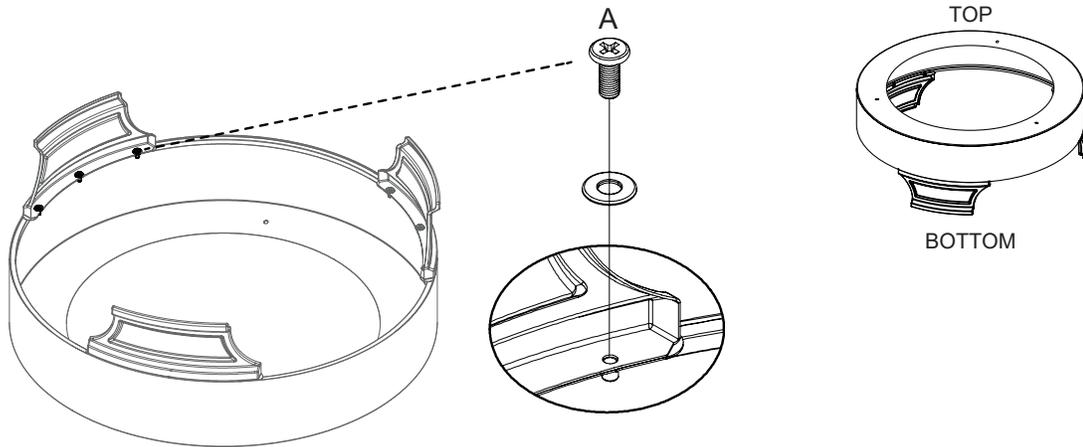
2- Retourner la base et assembler les grilles supérieures sur la base. Chaque écran est muni d'une vis qui s'insère dans le trou de la base et de deux languettes qui se raccordent à l'écran adjacent à l'aide de vis. Les moustiquaires peuvent être installées dans n'importe quel trou, mais il est plus facile de commencer par la moustiquaire qui comporte la charnière de la porte et d'installer le cadre avec la porte en dernier.
