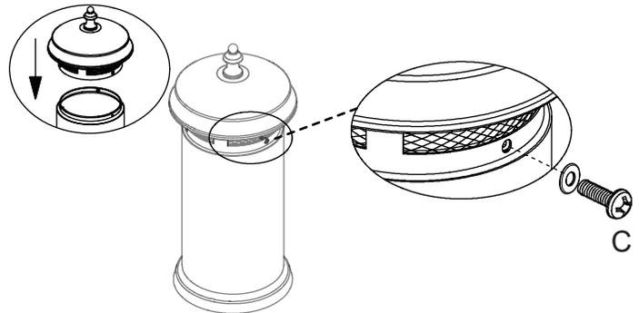
8 - Monter la cheminée sur le bouclier thermique supérieur. Ajustez bien puis tournez lentement dans le sens inverse des aiguilles d'une montre jusqu'à ce que les 4 languettes s'enclenchent fermement en place.
