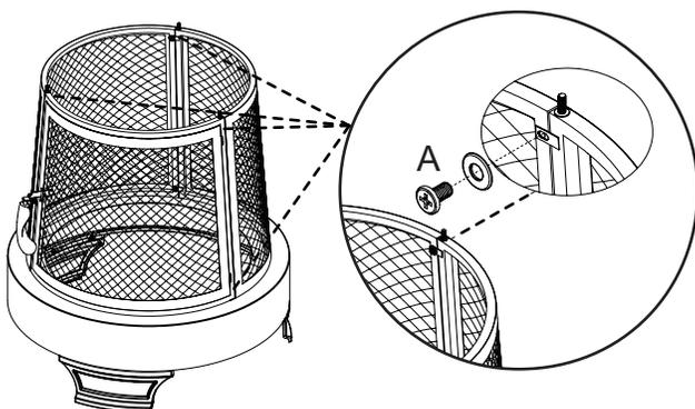
4- Raccorder le bouclier thermique et fumigène supérieur à la carrosserie. Veillez à ne pas endommager le filetage des boulons lors de l'installation. Il y a trois points de fixation. Passez par le haut et utilisez une rondelle et un écrou sur chaque vis pour la fixer.
