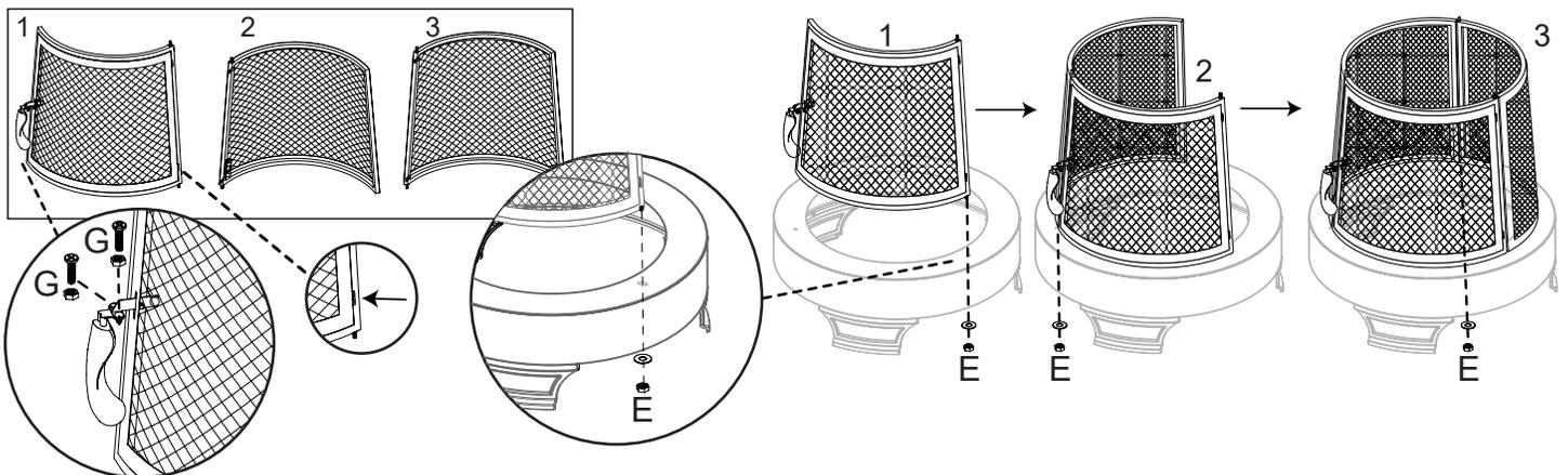
3- Fixer les écrans entre eux à l'aide des vis et des rondelles, en veillant à prendre le haut et le bas.
